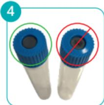
**4** Vuelva a enroscar la tapa de forma segura: **NO LA AJUSTE DEMASIADO.** La tapa debe enroscarse hasta el punto de resistencia. Si ve una hendidura en el interior, afloje la tapa y vuelva a enroscarla para asegurarse de que el sellado sea correcto.
